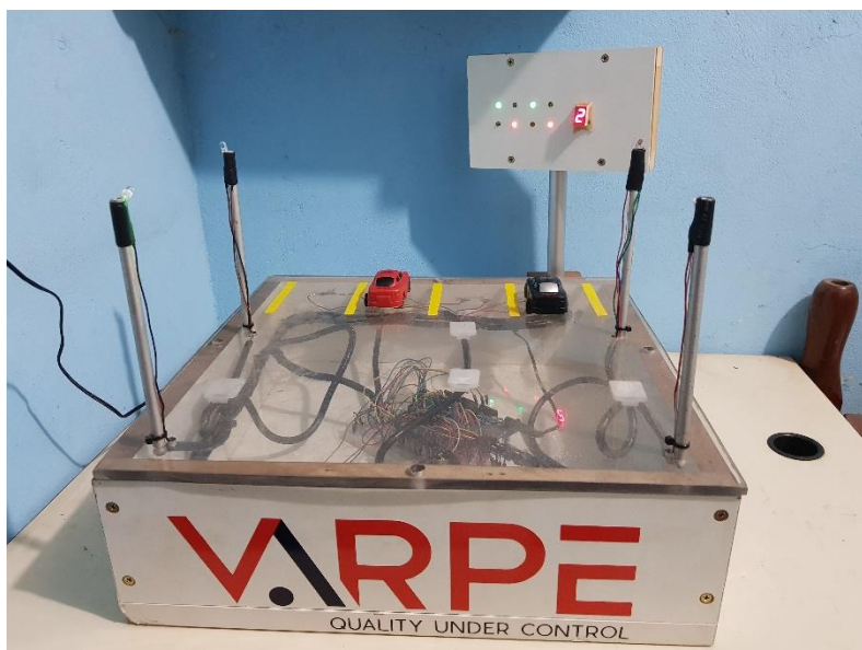
Figura 1 - Maquete do Sistema Automatizado de Estacionamento
