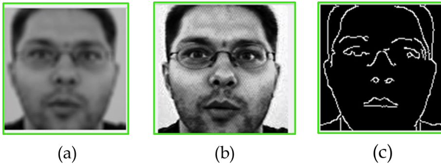
Figura 3 – Etapa 2 do Processamento da Imagem: Em (a), imagem com o filtro Gaussiano; em (b), imagem com Filtro Equalização de Histograma; e em (c) extração das feições através das Bordas Canny.
